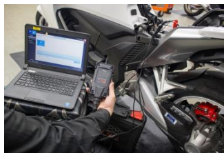
輸入二輪車の作業前のエラー状況と作業後の状況を診断できます
